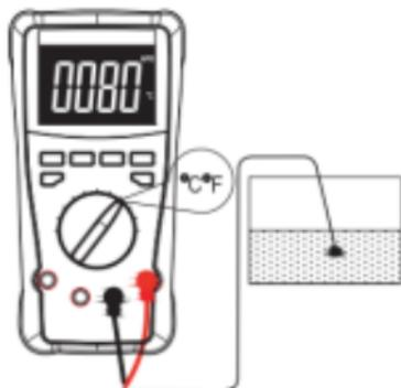
**Hinweis:** Bei hohen Temperaturen wird die Lebensdauer des Temperaturfühlers verringert. Der beiliegende Fühler ist bis 250°C spezifiziert. Bei höheren Temperaturen verwenden Sie bitte andere Typ-K Fühler.
