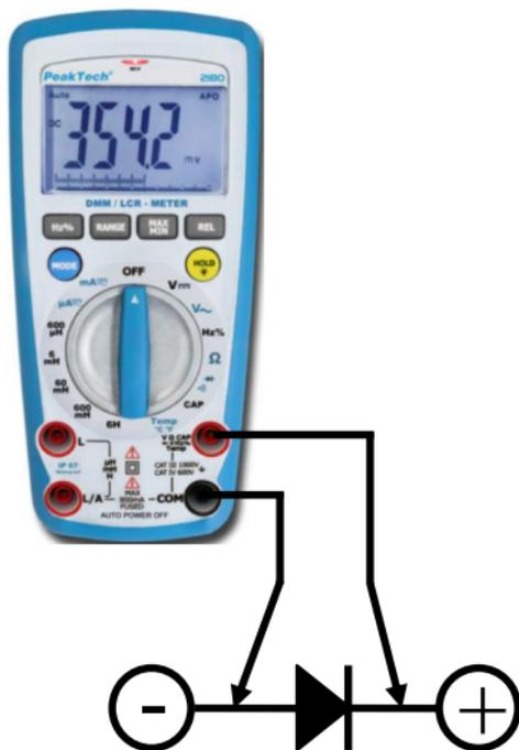
1. Funktions-/Bereichswahlschalter in Stellung Diodentest drehen.
