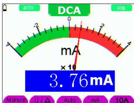
Fig. 27: Medición de corriente CC para <400 mA
