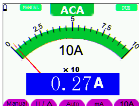
Figure 30: Medición de corriente CA para <10 A
