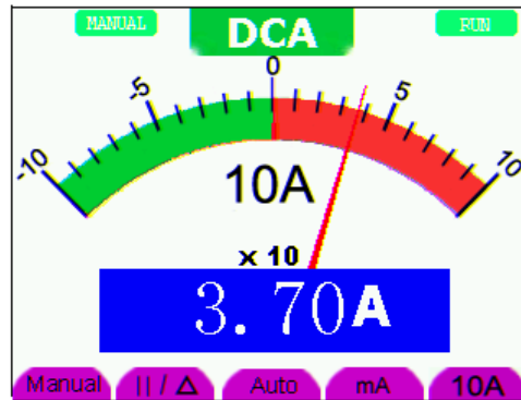
Fig. 28: Medición de corriente CC para <10A
