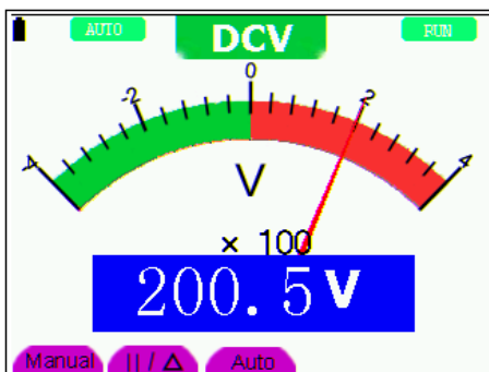
Fig. 25: Medición de tensión CC
