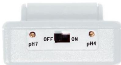
Para calibrar la unidad, se necesitan dos soluciones de calibración con un valor de pH de 4,01 y 7,01 a temperatura ambiente.
