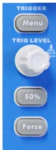
Fig. 0-11Panneau de commande des déclencheurs
