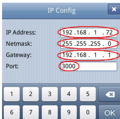
Fig. 0-7 Réglage des paramètres du réseau dans l'oscilloscope
