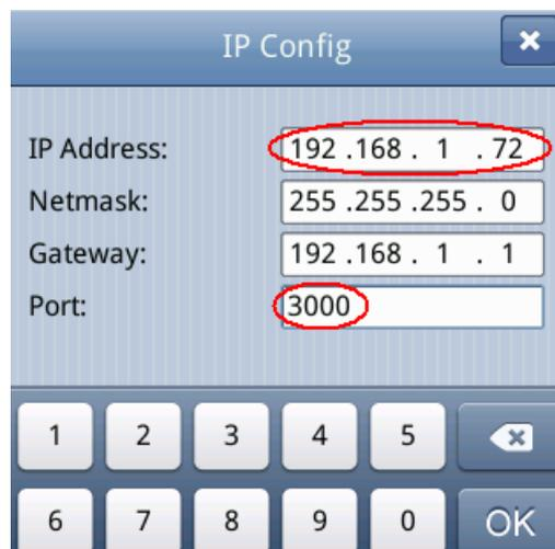
Fig. 0-4 Réglage des paramètres du réseau dans l'oscilloscope
