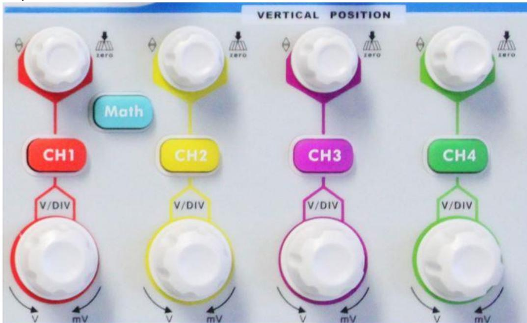
Fig. 0- 9Panneau de commande vertical
