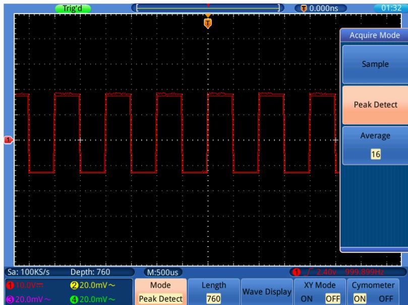
**Frame 0-2**Max Mode de détection, qui peut être utilisé pour détecter les pics du front descendant et pour détecter le bruit.
