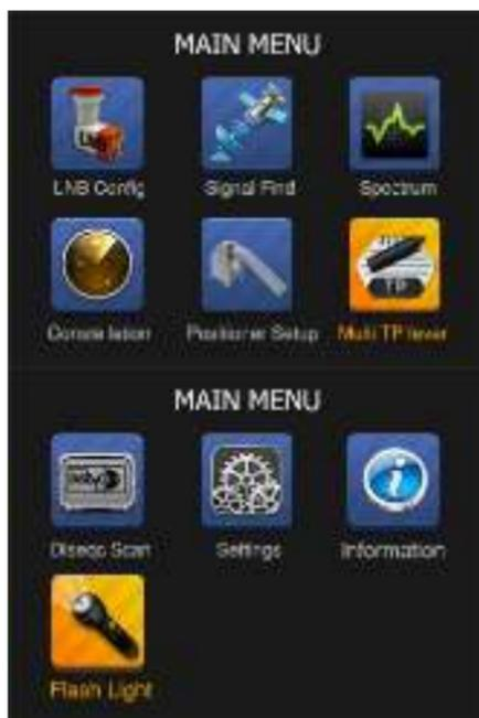
Navegue con los cursores (izquierda, derecha, arriba, abajo) para seleccionar la función deseada y confirmar la selección con la tecla OK.
