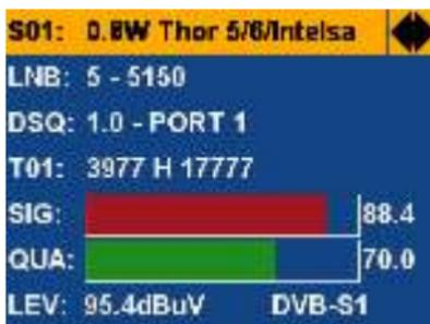
1. Pulse OK para mostrar la información de la señal (nivel, ratio portadora/ruido y tasa de error/bit).
