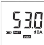
Se il livello sonoro viene rilevato al di sopra del valore impostato, l'unità emette un segnale acustico e visivo (il LED lampeggia) a seconda dell'impostazione.
