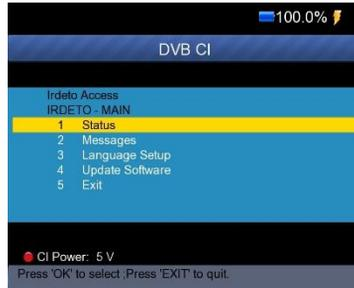
A continuación, puede comprobar la información del módulo CI con este elemento. Además, puede cambiar la potencia del módulo CI a 3V / 5V / Auto con el botón rojo (0 / 22k).
