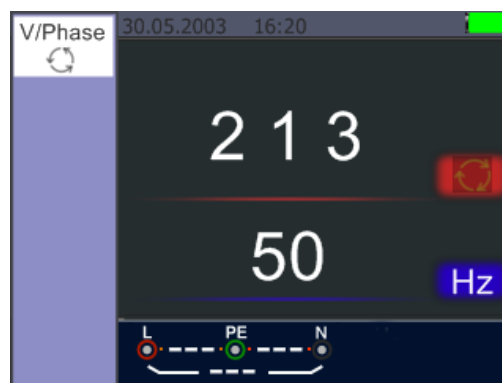
Zwei Phasen vertauscht (linksdrehendes Drehfeld)
