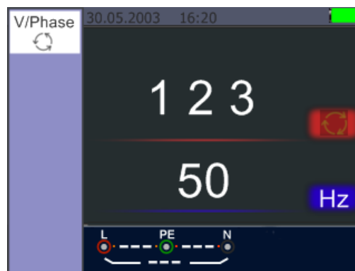
Richtige Phasensequenz L1, L2, L3 (rechtsdrehendes Drehfeld)
