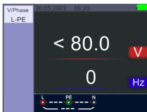
Standby Anzeige der Spannungsmessung (< 80V)
