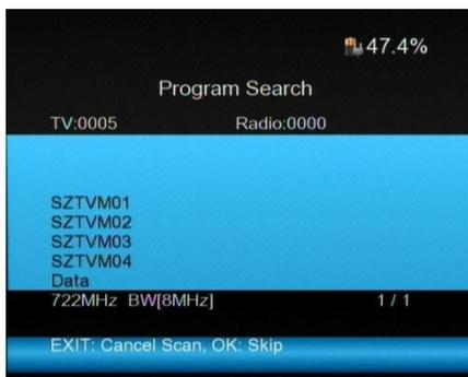
6. **Ricerca automatica:** Avvia la ricerca dei canali sull'intero spettro di frequenza DVB-T con il tasto OK. Con il tasto ◀Sinistra/Destra▶ è possibile selezionare in anticipo se cercare "Tutti" i canali, inclusa la Pay TV, o "Solo FTA", per cui i canali criptati non vengono elencati. I canali trovati sono elencati in una tabella, come mostrato nella ricerca TP della sezione precedente.
