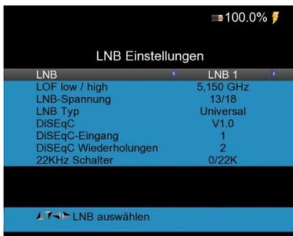
1. **LNB:** è possibile impostare 16 diversi LNB con diverse configurazioni. Selezionare l'LNB desiderato con i tasti freccia ◀Sinistra/Destra▶.
