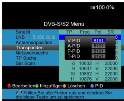
5. **Ricerca della rete:** se la ricerca della rete è attivata, il misuratore può ricevere informazioni aggiuntive dal transponder, ad esempio per trovare nuove stazioni che non sono ancora state memorizzate nei dati interni del dispositivo. Premere i pulsanti ◀Sinistra/Destra▶ per cambiare l'opzione.
