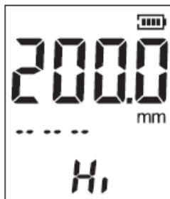
Réglage de l'alarme haute
