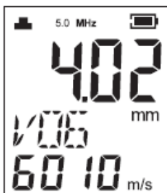
Mesure de l'épaisseur du matériau
