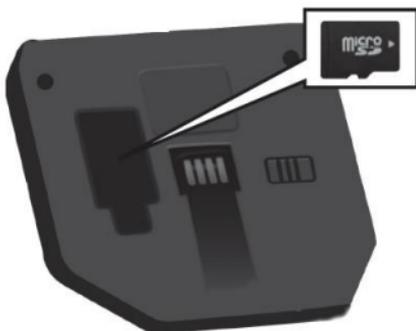
Retire el monitor usando el cierre deslizable (3) de la unidad principal. Abra la tapa como se muestra en la ilustración anterior e introduzca la tarjeta micro SD en el soporte provisto. En el momento de la entrega, la tarjeta micro SD ya está insertada en el dispositivo.
