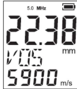
Messung der Materialstärke abgeschlossen, entfernen Sie den Sensor.
