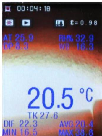
En el modo de grabación de video, se mostrarán los mismos valores de medición que en el modo de fotografía. Estos valores se pueden activar y desactivar en el submenú "MEASURE SET", al que puede entrar pulsando la tecla Enter en el modo de cámara IR.
