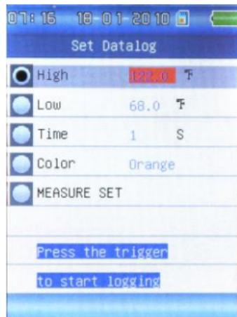
Esta función permite mediciones a largo plazo y almacenamiento de datos de valores medidos en un informe en forma de tabla. Se puede acceder a las tablas de almacenamiento de datos en el PC para un procesamiento posterior.
