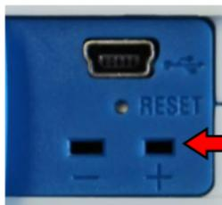
Este dispositivo está equipado con un sensor multifunción tipo K. Es el único sensor externo del dispositivo y se debe usar con el conector tipo K (+ -), el cual está colocado en el panel de servicio. Se puede usar también con cualquier otra sonda tipo K.
