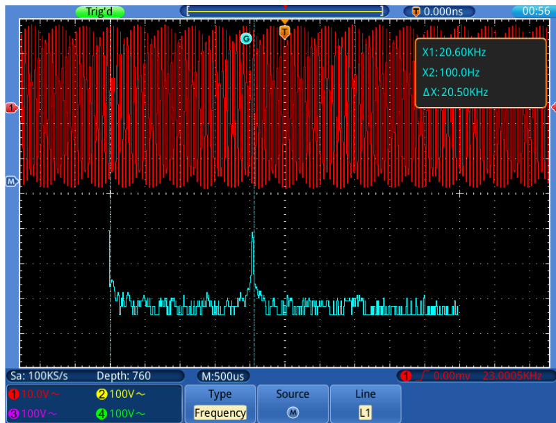
Bild 0-13 Frequenz- Cursormessung im FFT-Modus
