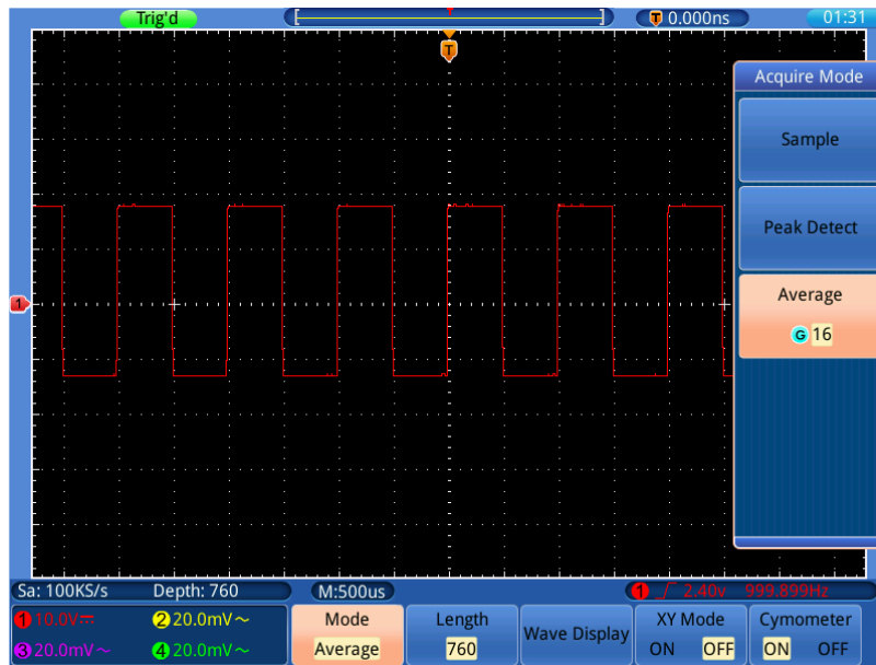
Bild 0-4 die angezeigte Wellenform nachdem das Rauschen mit dem Average Mode entfernt wurde. Die Mittelwertnummer wurde eingestellt auf 16.
