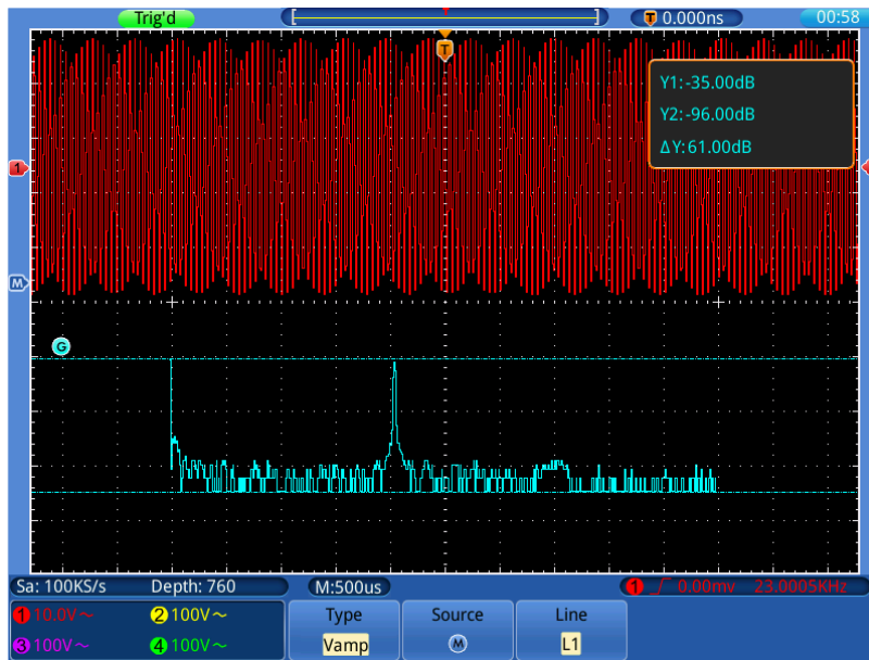
Bild 0-9 Amplituden Cursor-Messung für FFT
