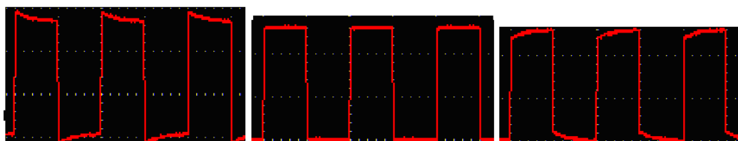
Überkompensiert korrekte Kompensation Unterkompensiert
