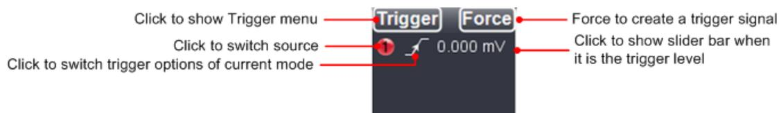
**Force :** Appuyez sur ce bouton pour créer un signal de déclenchement. Cette fonction est principalement utilisée avec les modes de déclenchement "Normal" et "Simple".
