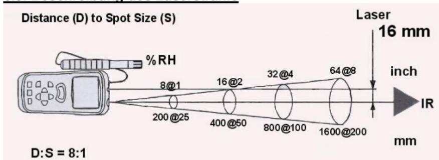
D = Entfernungsfaktor (Strahlausleuchtfläche in Ab-hängigkeit von der Entfernung) ca. 8:1
