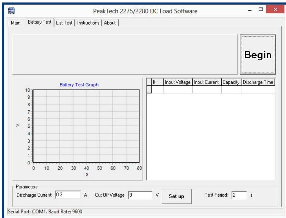
Haga clic en la pestaña “Battery Test” para realizar una prueba de batería. El campo “Parameters” incluye los ajustes necesarios para la prueba. Haga clic en “Set up” para aplicar los parámetros. El botón “Start/Begin” activará la carga e iniciará la prueba. Haga clic en “Stop” para pausarla. Durante la prueba verá la tabla con el muestreo de datos y la gráfica. Además, los datos se escribirán en el archivo “db.mdb”. Puede abrir el archivo para su evaluación en MS Excel o Access.
