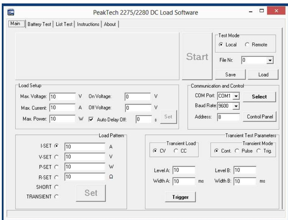
Poco después de haber ejecutado el software, verá la pestaña “Main” abierta. En la parte derecha, en “Communication and Control”, tendrá los ajustes necesarios para conectar el software al puerto deseado. Introduzca aquí sus valores y haga clic “Select” y, seguidamente, en “Connect”. Observará el
