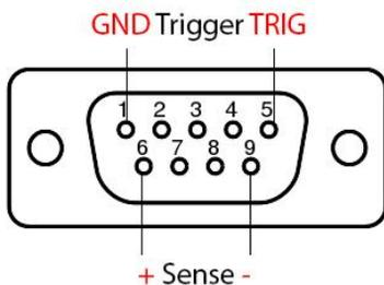
**Disparo:** Pin 1: Tierra (GND), Pin 5: Disparo. Para activar el disparo, conecte el Pin 5 a GND. **¡Nunca aplique tensión externa a estos pines!**
