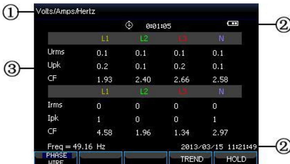
Dieser Bildschirm gibt eine sofortige Übersicht über wichtige numerische Messwerte. So wie der Tabellen-Bildschirm unter Spannung / Strom / Frequenz-Modus.
