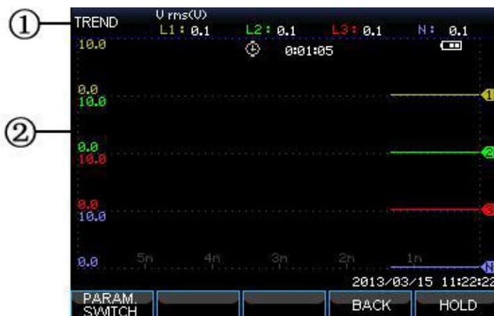
Trend zeigt den zeitlichen Verlauf der Messwerte aus der Tabelle an. So wie die Einbrüche (Dips) & Spitzen (Swells) -Zeit horizontal angezeigt wird, wird der Trend allmählich von der rechten Seite des Bildschirms aufgebaut.
