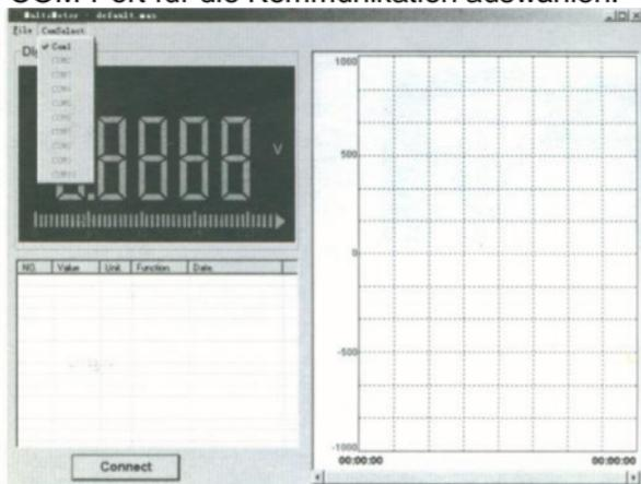
8. Multimeter einschalten und dann die USB-Taste 2 Sekunden gedrückt halten, um die Schnittstelle des Gerätes zu aktivieren und somit die Abschaltautomatik auszuschalten. Im Display wird das "PC-LINK"-Symbol angezeigt.
