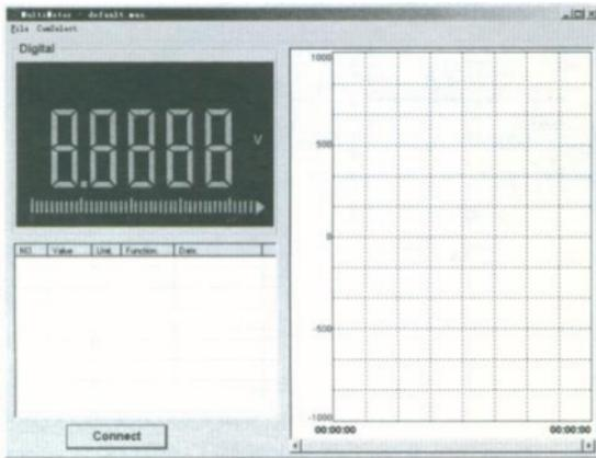
7. Mit Hilfe des Menüpunktes "COM SELECT" den korrekten COM-Port für die Kommunikation auswählen.
