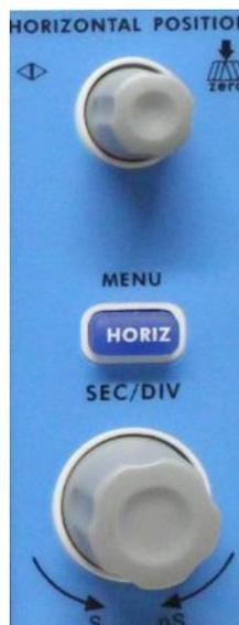
**Fig. 12** Éléments de commande pour le contrôle horizontal
