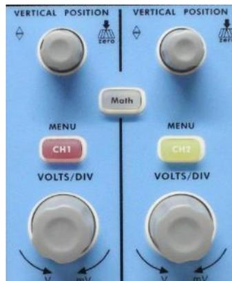
**Fig. 11** Éléments de commande pour le contrôle vertical
