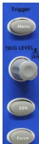
**Fig. 13** Éléments de contrôle des déclencheurs
