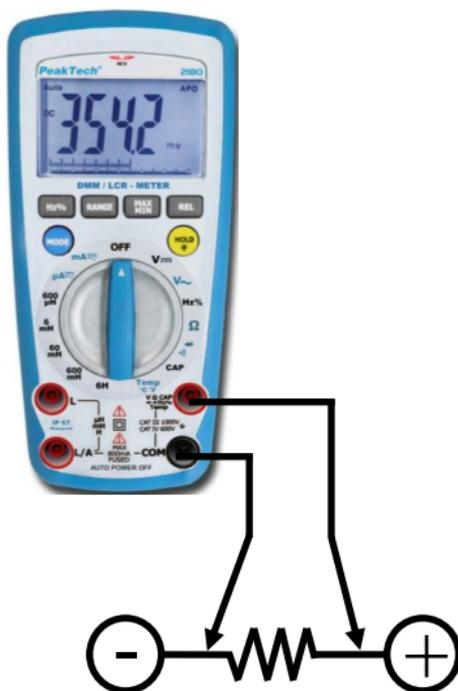
El circuito de medición de resistencia comparará la tensión obtenida mediante una resistencia conocida (interna), con la tensión desarrollada a través de la resistencia desconocida. Por tanto, cuando compruebe la resistencia en circuito, asegúrese de que el circuito bajo prueba está completamente sin alimentación (todos los condensadores completamente descargados).
