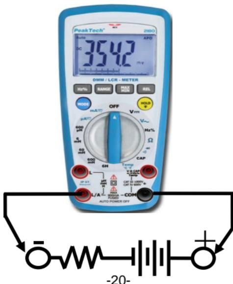
1. Coloque el selector en el rango  $\mu\text{A}$  o  $\text{mA}$  que desee. Si no conoce el nivel de corriente, sitúelo en la posición más alta y vaya reduciendo según necesite para obtener una lectura.
