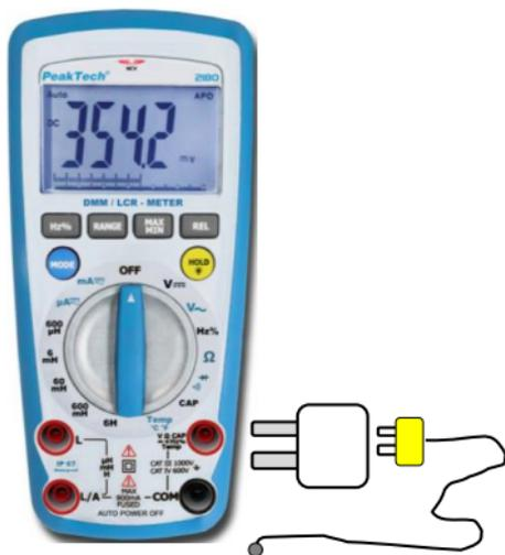
1. Si desea medir la temperatura coloque el selector en el rango °C o °F.
