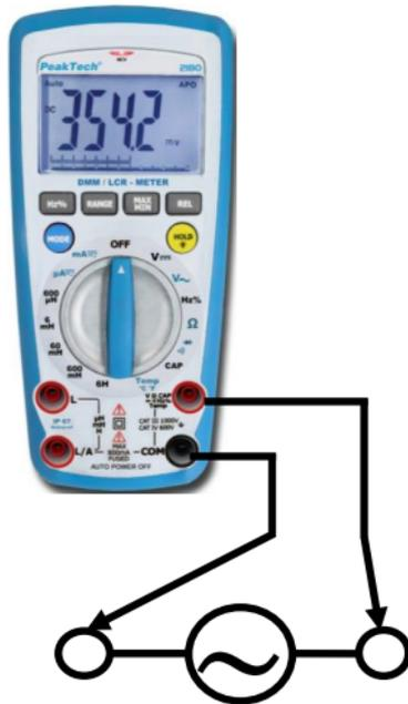
**¡Advertencia!** Cuando conecte las sondas de test a una toma CA/fuente, no gire el selector hacia otro rango, ya que podría dañar los componentes internos del medidor o a sí mismo.
