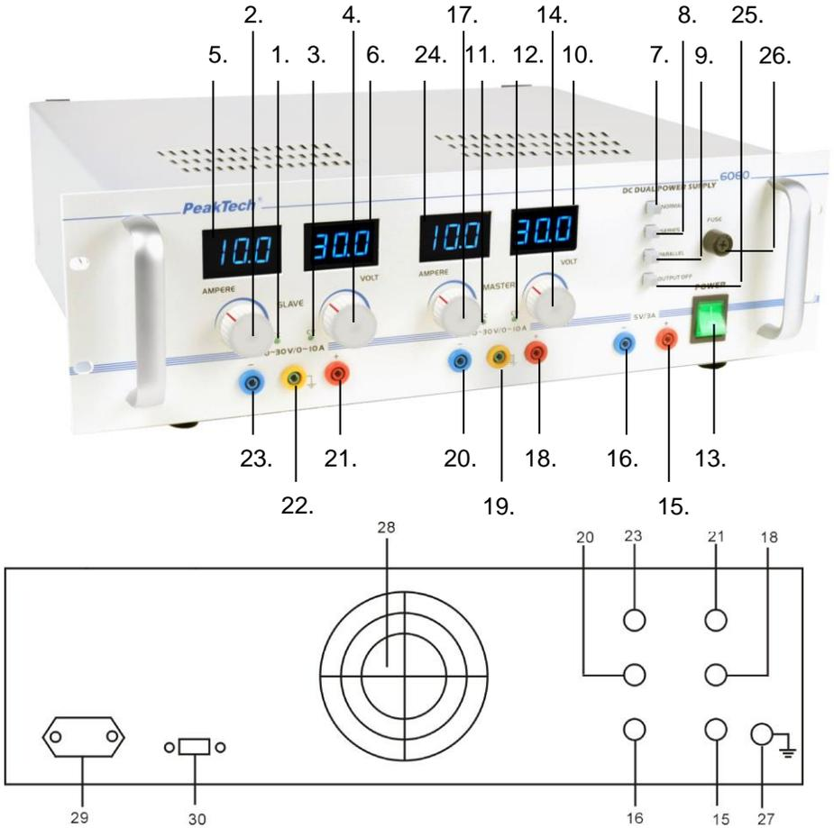
1. Indicador esclavo de corriente constante o indicación de estado en paralelo de dos canales: el LED se ilumina cuando la salida esclava está en el estado de corriente regulada o cuando las dos salidas regulables están en paralelo.
