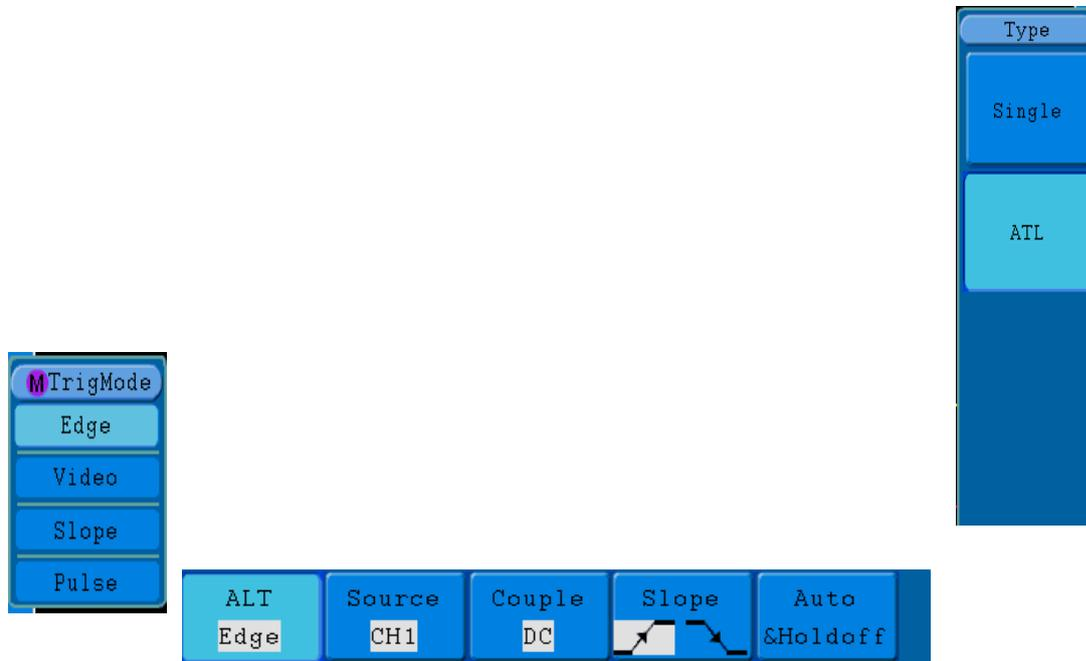
**Fig.34** Menu per l'attivazione alternata (ALT) (tipo di attivazione: Edge)
