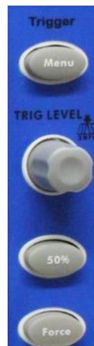
**Fig. 13** Elementi di controllo per i trigger
