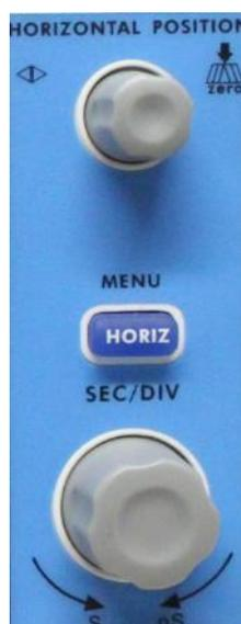
Fig. 12 Elementi di comando per il controllo orizzontale
