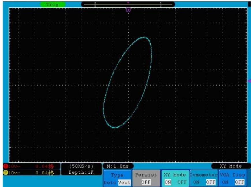
Fig. 46 Formato di visualizzazione XY
