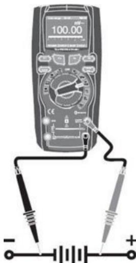
1. Sélecteur de fonction en position  $mV \overline{\sim}$
