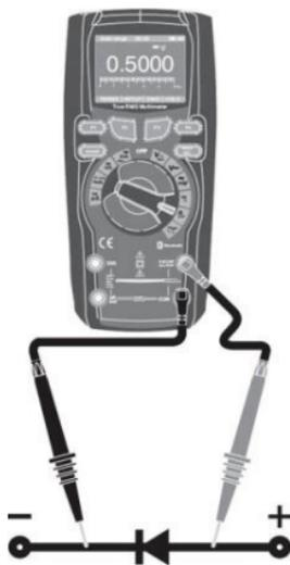
1. Tourner le sélecteur de fonctions en position  $\Omega \rightarrow \text{---} | \text{---} / \text{CAP}$ .
