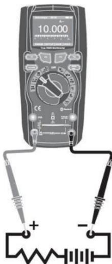
1. En fonction du courant à mesurer, tournez le sélecteur de fonction sur la position  $\mu\text{A}$ , mA ou 10A.
