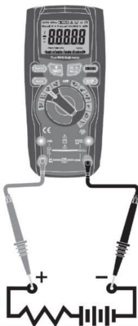
1. Tournez le sélecteur de fonction sur la position  $\mu\text{A}$ , mA ou 10A en fonction du courant à mesurer.
