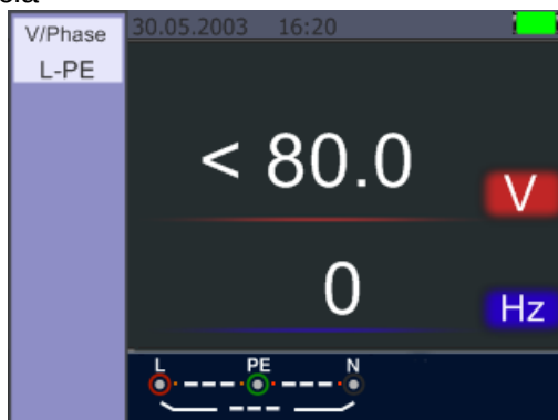
Pantalla de Standby para tensión y frecuencias
