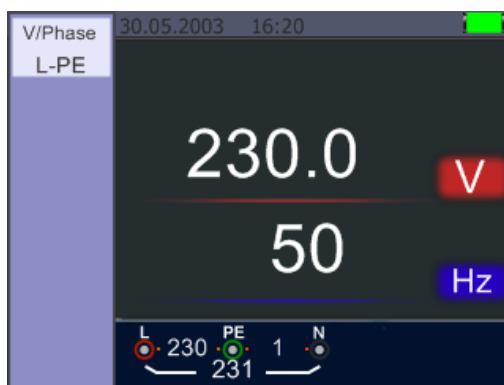
Pantalla en medición de tensión y frecuencia
