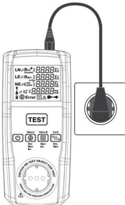
Dès que le testeur d'appareils est allumé et que la fiche pour appareils froids est branchée dans la prise de courant avec contact de protection, l'appareil démarre automatiquement la mesure de tension. La polarité des câbles s'affiche alors :
