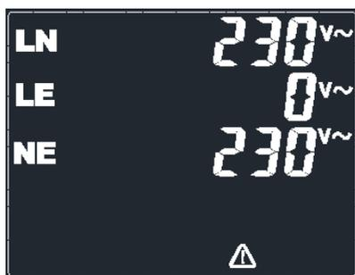
LN : tension entre le conducteur extérieur (L) et le conducteur neutre (N)
