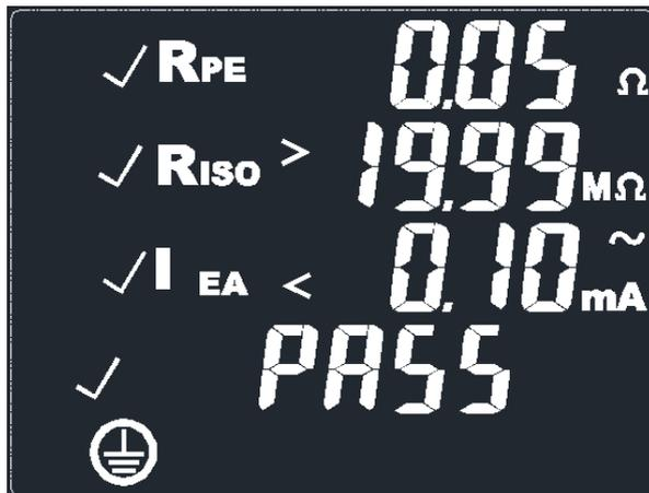
Une fois le contrôle de la résistance de la conducteur de protection, de la résistance d'isolement et du courant de fuite réussi, l'appareil affiche la mention « PASS » pour indiquer que les contrôles effectués sur l'appareil testé ont été réussis.
