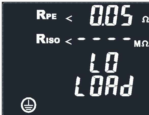
Pour poursuivre le test, mettez l'appareil testé sous tension et le testeur d'appareils reprend automatiquement le test.
