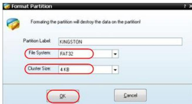
Figura 4-8: Ajuste del formato
