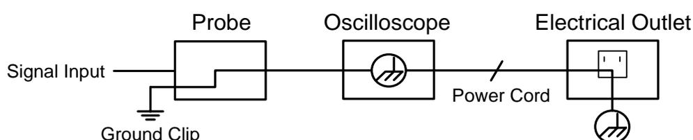
No está permitido medir la potencia de CA cuando el osciloscopio alimentado por CA está conectado al PC alimentado por CA a través de los puertos.
