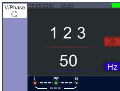
Richtige Phasensequenz L1, L2, L3 (rechtsdrehendes Drehfeld)
