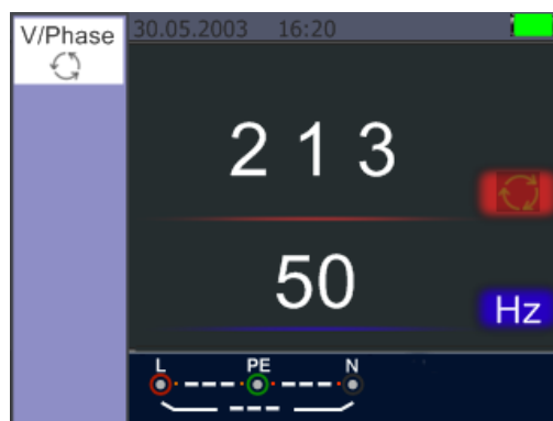
Zwei Phasen vertauscht (linksdrehendes Drehfeld)
