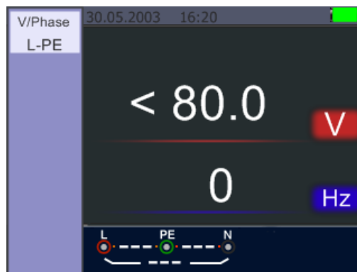
Standby Anzeige der Spannungsmessung (< 80V)
