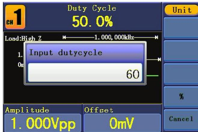
Fig. 0-8: Ajuste del ciclo de trabajo de la señal cuadrada
