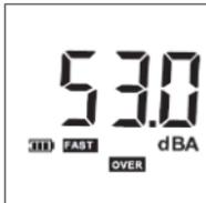
Si le niveau sonore est détecté au-dessus de la valeur réglée, l'appareil émet un signal acoustique et visuel (la LED clignote) en fonction du réglage.
