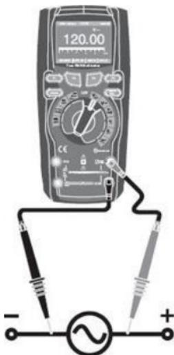
1. Coloque el selector en la posición "V~".
