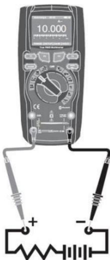
1. De acuerdo con la corriente que se vaya a medir, gire el selector de función a la posición de  $\mu\text{A}$ , mA o 10A.
