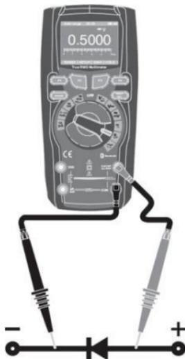
1. Coloque el selector en la posición " $\Omega$ — $\rightarrow$ — $|$ —/CAP".
