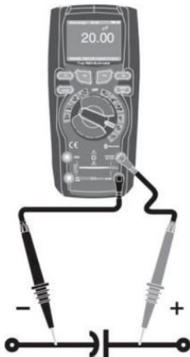
1. Coloque el selector en la posición " $\Omega \rightarrow | \text{---} |$ /CAP".
