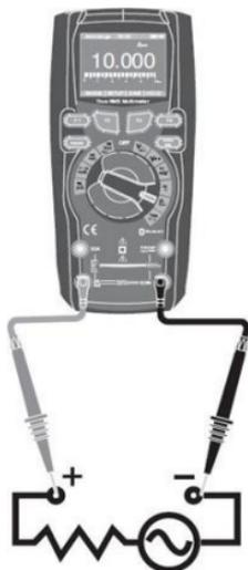
1. Inserte la sonda de test negra en el conector negativo COM.
