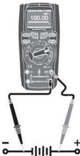
1. Coloque el selector en la posición  $mV\tilde{}$
