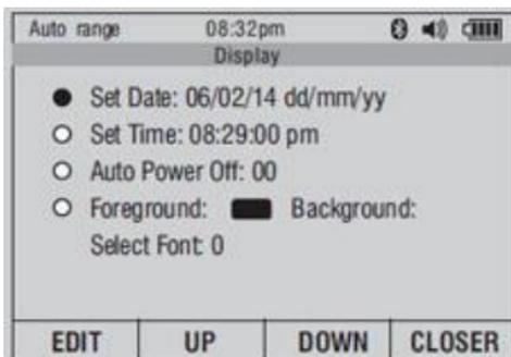
Abra el menú "Save", pulsando la tecla "F3" (SAVE). Pulse la tecla "F3" (DOWN) para seleccionar el elemento "SETUP" del menú y luego "DISPLAY" y confirme con "F1" (ENTER).
