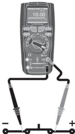
1. Coloque el selector en la posición " $\Omega$  /
