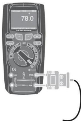
1. Coloque el selector en la posición “TEMP °C/°F”.
