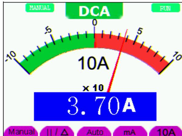
Fig. 24: Medición de corriente CC para 10 A
