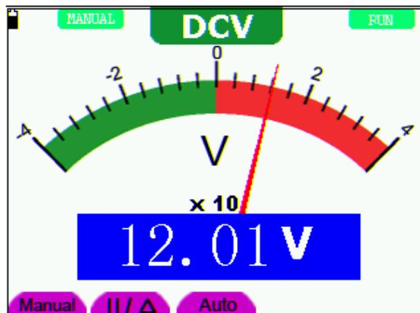
Fig. 29: Selección entre rango manual y automático
