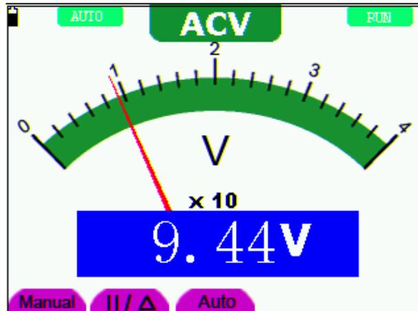
Fig. 22: Medición de tensión CA
