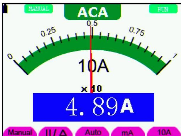
Fig. 26: Medición de corriente CA para 10 A
