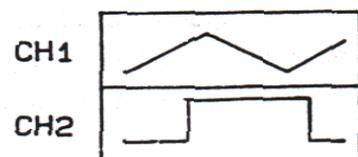
Abb. 2-17: Signaldehnung mit Hilfe des Zeitbasisreglers
