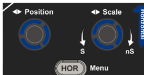
Figure 2-11 Zone de contrôle horizontale
