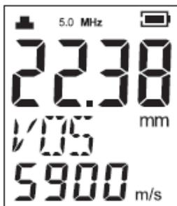
Ben accoppiato e in fase di misurazione dello spessore del materiale
