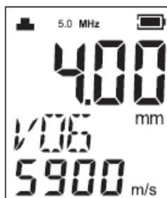
Misura della velocità del suono
