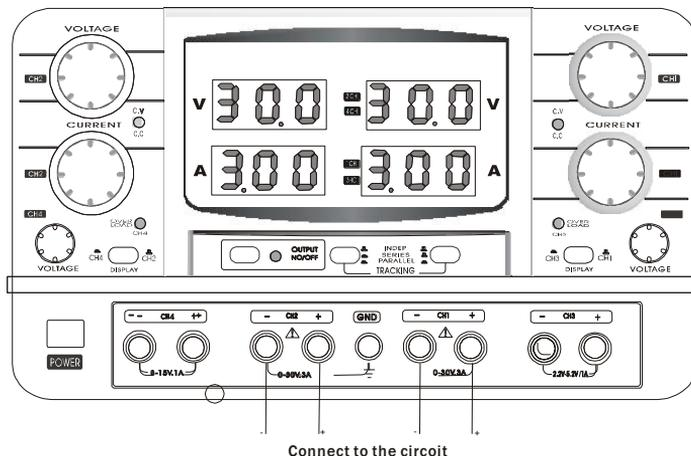
1. Schließen Sie das Netzteil an eine Stromquelle.
