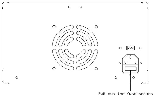
1. Trennen Sie sämtliche Verbindungen und Stromanschlüsse vom Netzgerät
