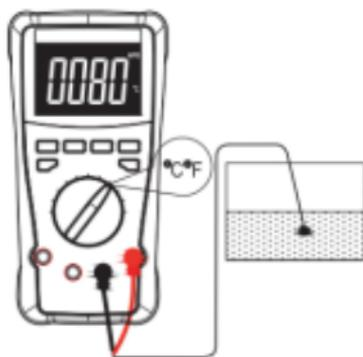
**Remarque :** à des températures élevées, la durée de vie du capteur de température est réduite. Le capteur fermé est spécifié pour des températures allant jusqu'à 250°C. Pour des températures plus élevées, veuillez utiliser d'autres capteurs de type K.
