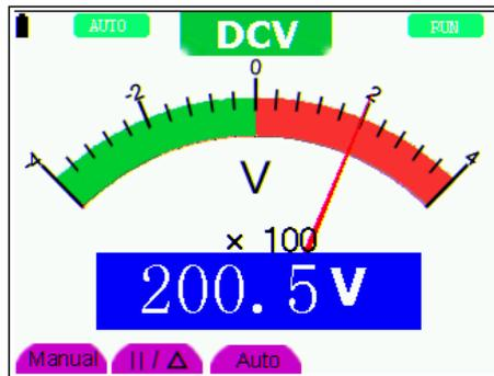
Figure 25 : Mesure de la tension continue (DCV)
