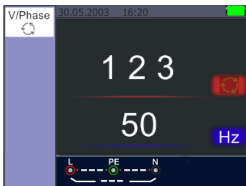
Prawidłowa kolejność faz L1, L2, L3 (pole wirujące w prawo)
