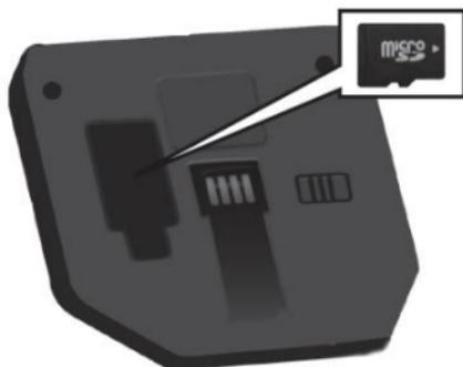
**Inserimento della scheda SD:** Rimuovere il monitor dall'unità principale utilizzando l'interruttore a scorrimento (3). Aprire il coperchio come mostrato nell'immagine e inserire con cautela la scheda SD nell'apposito supporto. Nello stato di consegna, la scheda SD è già inserita nell'unità.
