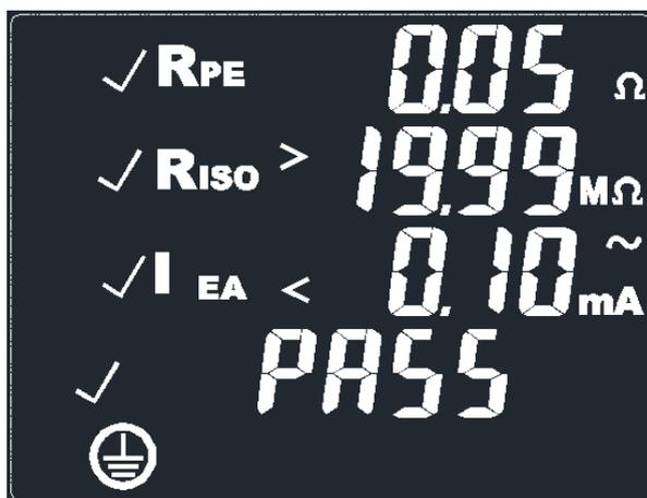
Dopo aver superato i test di resistenza del conduttore di protezione, di resistenza di isolamento e di corrente di dispersione, il dispositivo indica il superamento dei test eseguiti sull'oggetto in prova con la dicitura "PASS".
