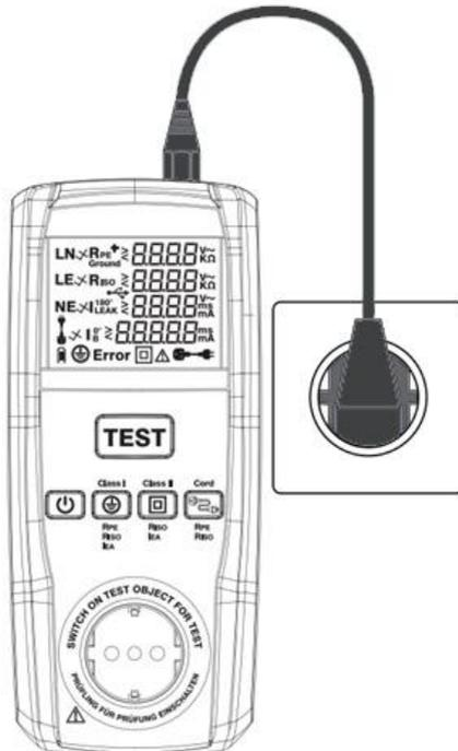
Non appena il tester per elettrodomestici viene acceso e la spina IEC viene inserita nella presa di sicurezza, il dispositivo inizia automaticamente a misurare la tensione. Viene visualizzata la polarità dei cavi:
