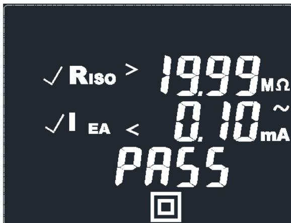
Per la misura della resistenza di isolamento di provini di classe di protezione III:
