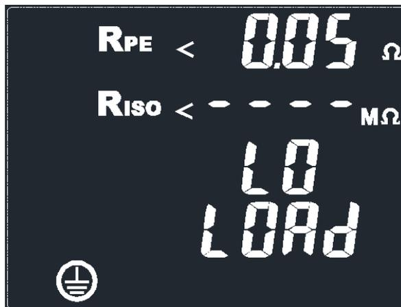
Per continuare il test, accendere il dispositivo in prova: il tester per elettrodomestici continuerà automaticamente il test.
