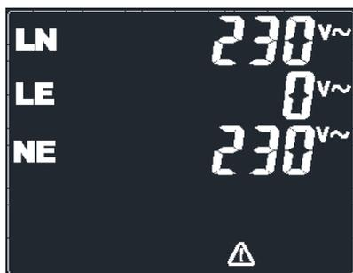
LN: Tensione tra il conduttore di fase (L) e il conduttore neutro (N)
