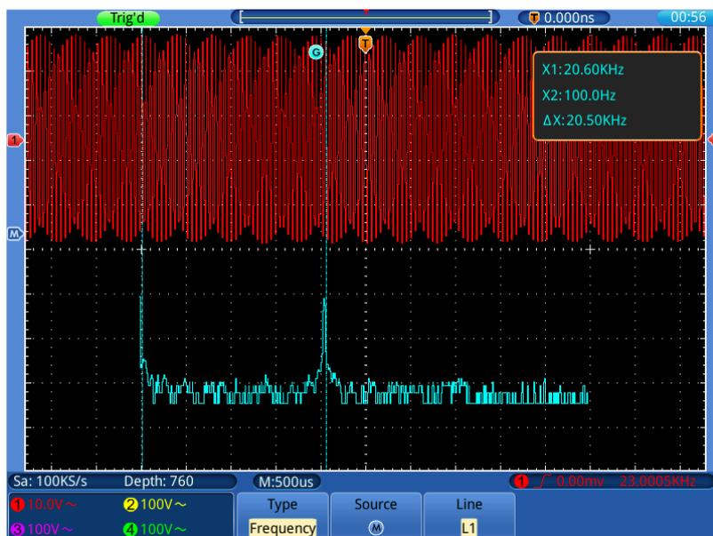
Figure 0-13 Onda de medición del cursor de frecuencia
