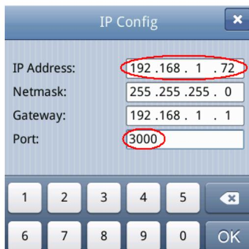
Fig. 0-4 Configuración de los parámetros de red del osciloscopio
