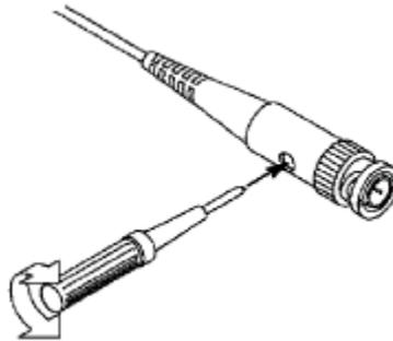
Figura 3-7 Ajustar la sonda
