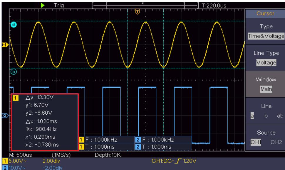
Figura 4-16 Medición del Cursor de Tiempo y Tensión
