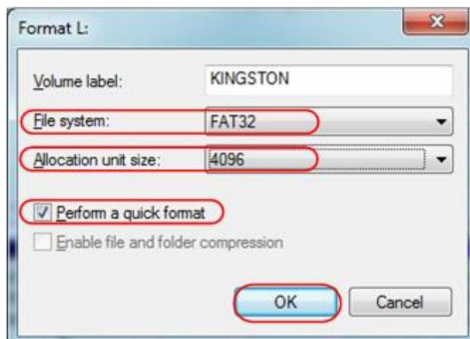
Figura 4-4: Formateo de la configuración del disco USB
