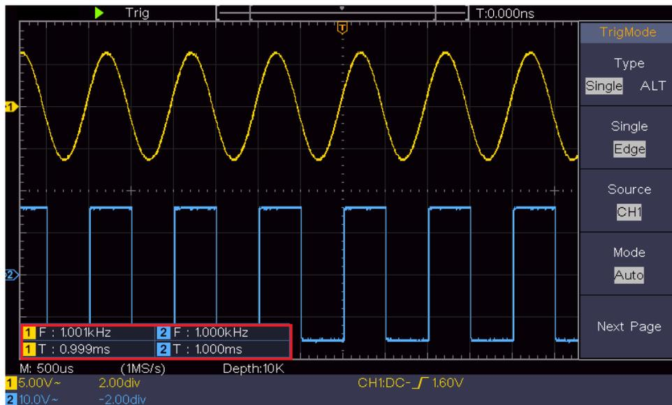
Figura 4-13 Medición automática
