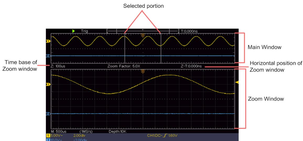
En el modo normal, los mandos de **Posición Horizontal** y **Escala Horizontal** se utilizan para ajustar la posición horizontal y la base de tiempos de la ventana Principal.
