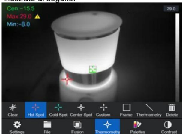
È possibile impostare il centro termico, il punto di temperatura più alto, il punto di temperatura più basso e il punto termico definito dall'utente.
