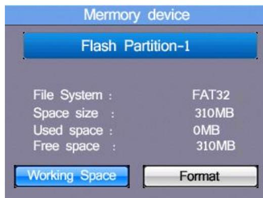
Pulse los cursores ◀ y ▶ para seleccionar entre “Working Space” o “Format”. Luego, pulse el botón □ (Enter) para acceder. Pulse el botón ESC para salir y guardar.
