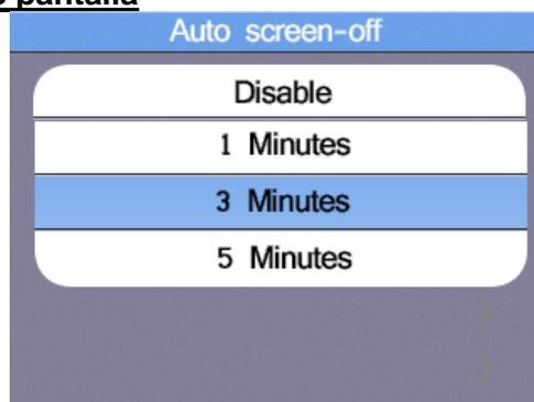
Es de 3 minutos por defecto. Pulse los cursores ▲ y ▼ para seleccionar el tiempo de apagado automático de pantalla deseado y pulse el botón ESC para salir y guardar.
