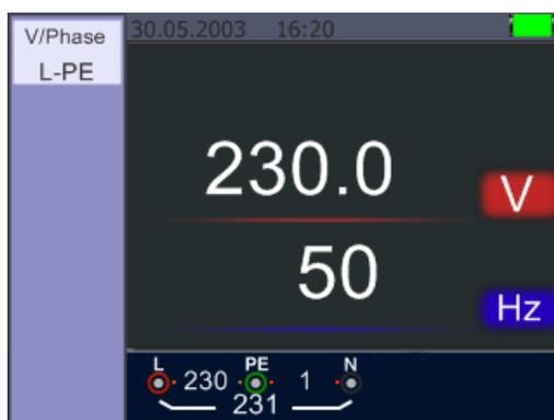
Pantalla en medición de tensión y frecuencia
