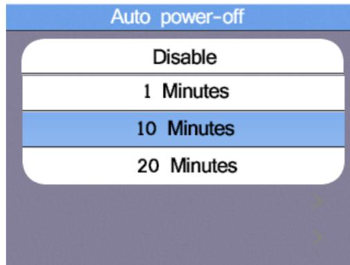
Es de 10 minutos por defecto. Pulse los cursores ▲ y ▼ para seleccionar el tiempo de apagado automático deseado y pulse el botón ESC para salir y guardar.
