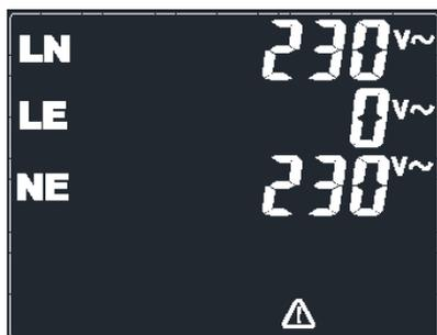
LN: Tensión entre el conductor de fase (L) y el conductor neutro (N)
