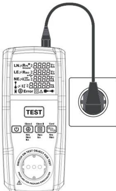
Al encender el comprobador de electrodomésticos y conectar el enchufe IEC a la toma de seguridad, el dispositivo comienza a medir la tensión automáticamente. Se muestra la polaridad de los cables:
