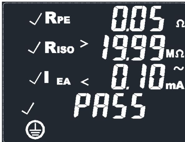
Después de pasar las pruebas de resistencia del conductor de protección, resistencia de aislamiento y corriente de fuga, el dispositivo indica la aprobación de las pruebas realizadas en el objeto de prueba con las palabras "PASS".
