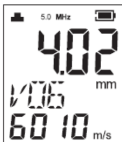
Pomiar grubości materiału
